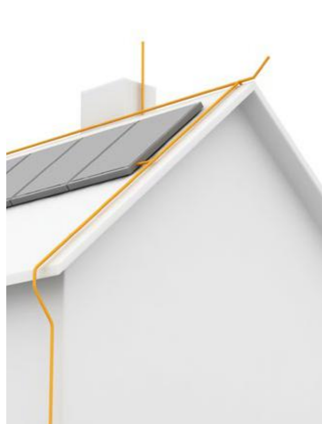
Direkter Anschluss der PV-Montagegestelle an das Blitzschutzsystem
